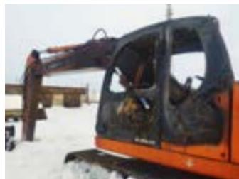
Наиболее сильное повреждение наблюдается в районе расположения отсека АКБ, кабины оператора.
